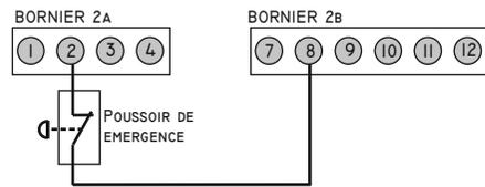
**N.B.:** Si vous n'utilisez pas la commande de STOP, faites un pont entre les bornes 2 - 8.
